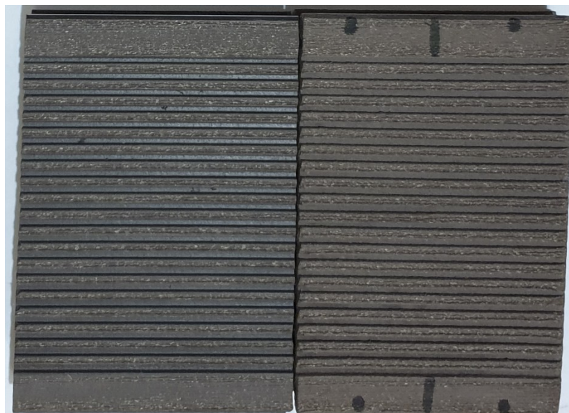
Фото образцов после выдержки в кипящей воде 2 часа
